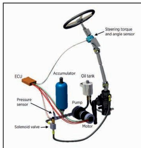
Avec la direction assistée hydraulique, le problème se situe souvent au niveau de la pompe, des fuites dans les conduites ou d'une courroie en V cassée
